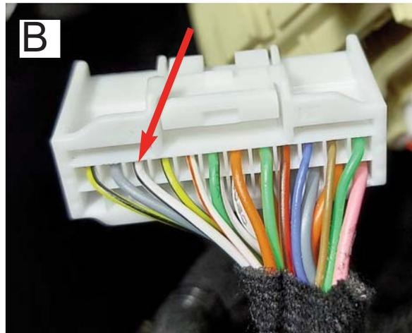
Interporre tra il filo **AZZURRO/VERDE** e il filo **ROSSO** del cablaggio allarme la resistenza da 4K7 ohm 1/4 w
